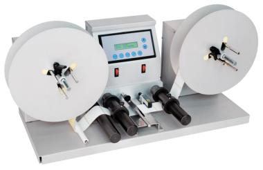
Employée en tant que réenrouleur, elle permet de rebobiner les étiquettes en partant de bobines ayant un diamètre max. de 300 mm enroulées de l'intérieur ou de l'extérieur, avec un mandrin de 46 m à 110 mm. sur des bobines ayant un diamètre max. de 300 mm. et déroulées de l'intérieur ou de l'extérieur. La vitesse moyenne de rebobinage est de plus de 50 m/minute.
