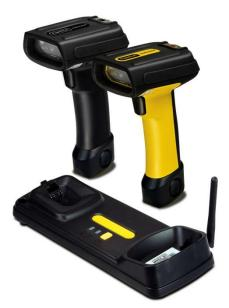
La base du PowerScan PB7 100 existe en deux modèles multi-interfaces : le modèle multi-interface Standard inclut le RS-232, Keyboard Wedge, Wand Emulation et USB; le second modèle (davantage dédié à l'environnement magasin) inclut le RS-232, IBM46xx et USB.
